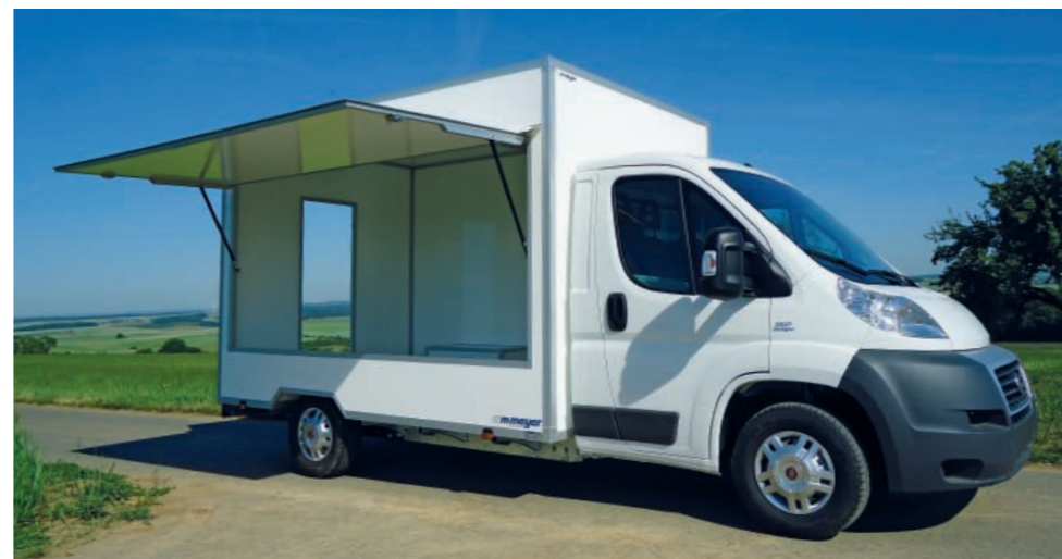
VMA 350 Aufbau Sandwichpolyester VMA 350 Panneaux en polyester sandwich VMA 350 Sandwich polyester panels
