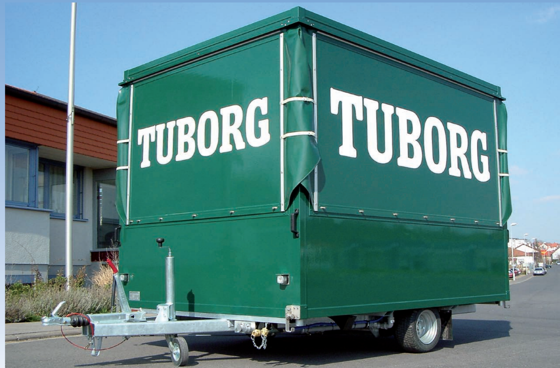
SVK 1325/200 Profi Zubehör: Stützrad verstärkt klappbar, vom Kunden vorgenommen: Lackierung SVK 1325/200 Profi Option : roue jockey renforcée automatique, ajouté par le client : peinture SVK 1325/200 Profi Optional extra: reinforced automatic jockey wheel, added by the customer: painted side panels
