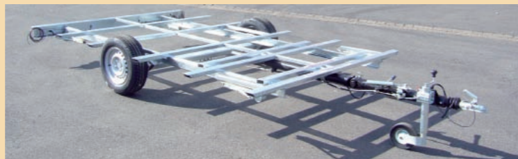
Abnehmbare Deichsel (1.300 / 1.600 kg, nur VK Profi) Timon démontable (1.300 / 1.600 kg, seulement VK Profi) Drawbar which can be taken off (1.300 / 1.600 kg, only VK Profi series)
