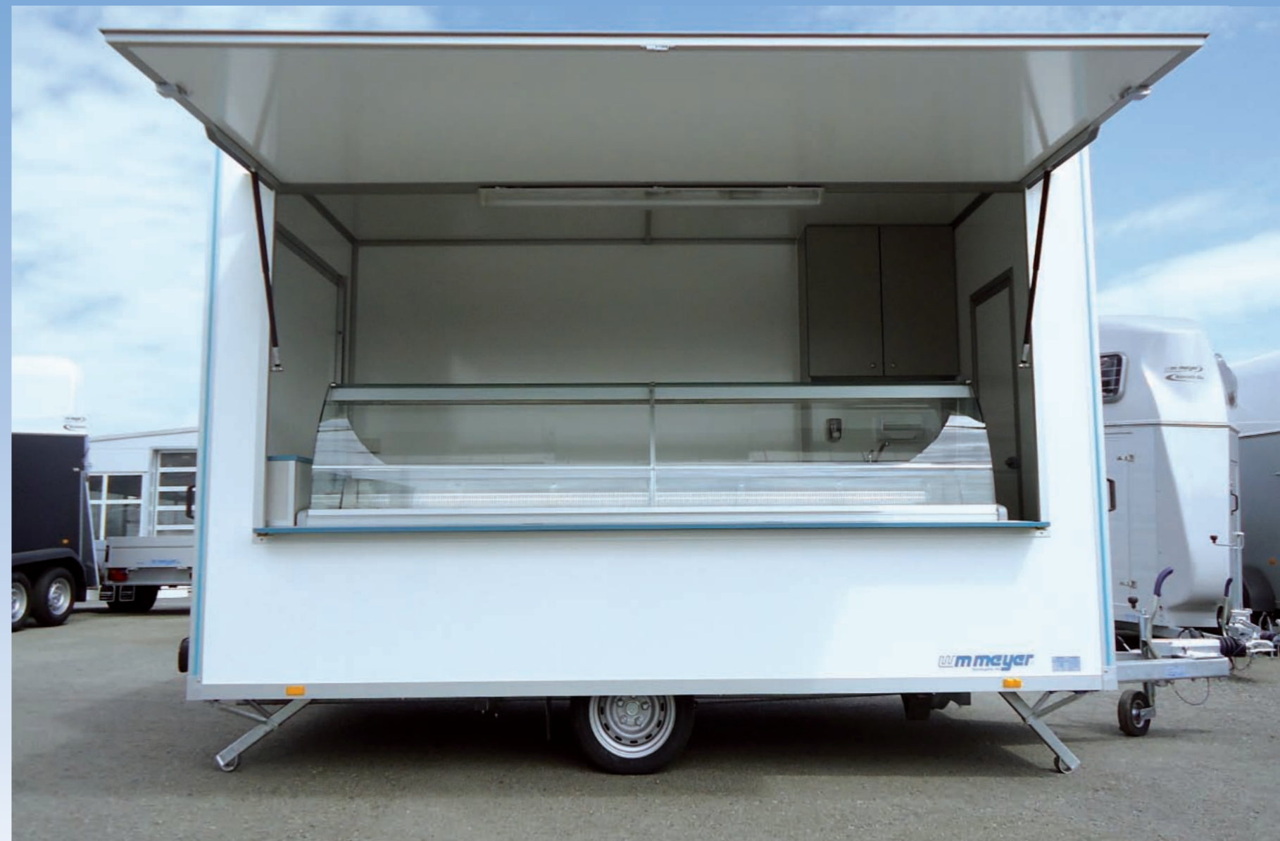
VKE 1537/206 Top Sonder Kühltheke, Sicherheitsglasaufbau, Beleuchtung, Kühltemperaturbereich: +1°/+10°C (bei ca. +35°C Umgebungstemperatur), Farbe weiß
