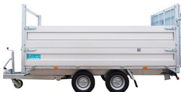
Simple rehausses AluMate500 (H= 50 cm)
