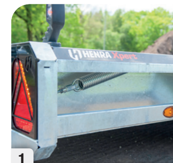
1 Verstelbaar veersysteem tbv achterklep
