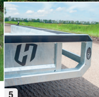
5 Robuste voorkant met ingebouwde breedteverlichting
