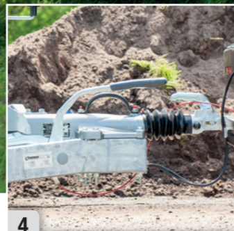
4 Geschroefde dissel met 2 koppelhoogte mogelijkheden
