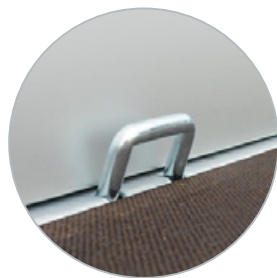
8 anneaux d'arrimage sur la tôle en acier
