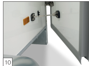
10 En série : portes isolées de 40 cm d'épaisseur, avec couche « gelcoat ».
