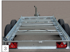
3 En série : châssis entièrement soudé et galvanisé à chaud pour double essieu.
