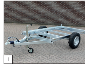
1 En série : châssis entièrement soudé et galvanisé à chaud pour essieu simple.
