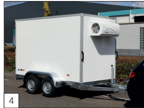
4 Option : remorque frigorifique double essieu jusqu'à 3 500 kg PTAC, dimensions maximales 400 x 180 x 210 cm.
