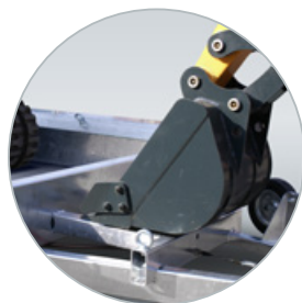
Emplacement godet de série sur le timon
