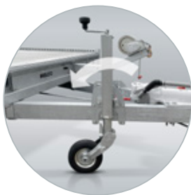
Option : La roue jockey rabattable pour prolonger l'avancement du véhicule
