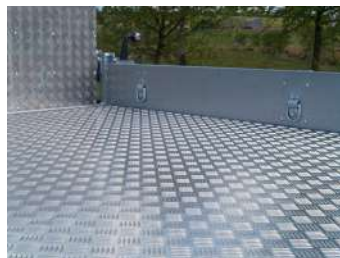
Plancher recouvert d'aluminium
