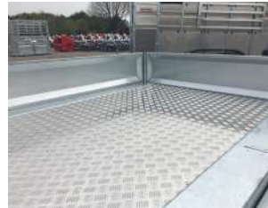
Plancher recouvert d'aluminium
