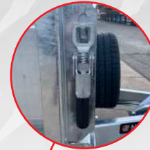
Des fermetures à ressort installés sur toutes les ridelles rabattables empêchent tout mouvement et bruit excessifs
