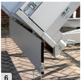
6 Bij hoogste kipstand komt het achterbord niet aan de grond en beschermd het tevens de achterlichten
