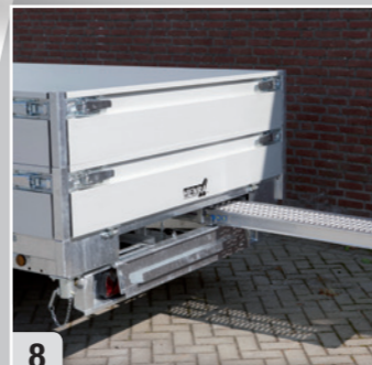
8 Slede gelast in chassis (t.b.v. rijplaten), Leverbaar met aluminium (of stalen) rijplaten (optie)
